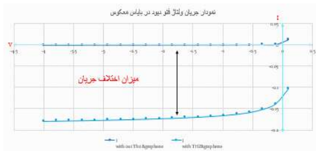
شکل ۴: منحنی V-I آشکارساز نوری در بایاس معکوس با حضور و عدم وجود لایه گرافن
