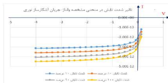
شکل ۶: نمودار VI آشکارساز نوری به ازای تغییر شدت تابش منبع نوری
