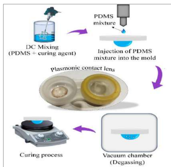
شکل ۱: طرحواره مراحل تولید لنز تماسی پلاسمونی بر پایه نانوذرات نقره، تصویر واقعی لنز پلاسمونی تولید شده، پیوست شده است.
