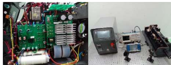
شکل ۳: لیزر دو پالسی به همراه منبع تغذیه ساخته شده.
