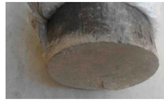
شکل ۳ مغزه کامل جدا شده از مخزن نفت آسماری اهواز.
