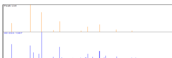
شکل ۱: طرح پراش اشعه x اکسید تنگستن سنتز شده با روش سل-ژل و مقایسه شدت قله‌ها در نمونه سنتز شده با شدت نمونه استاندارد.
