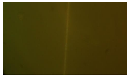
شکل ۳: موجبر با توان 4mw نوشته شده بعد از اچ که در محیط عادی حلال آن خارج شده
