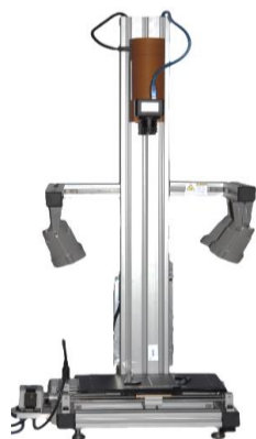
شکل ۱: دوربین تصویربردار فراطیفی نصب شده بر روی اسکنر و منبع نور هالوژن
