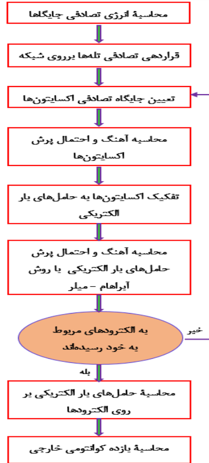
شکل ۲- فلوجارت شبیه‌سازی به روش مونت کارلو.
