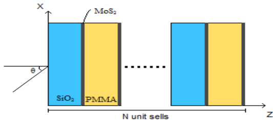
شکل ۱: ساختار بلور فوتونی یک بعدی حاوی مولیبدن دی سولفاید.
