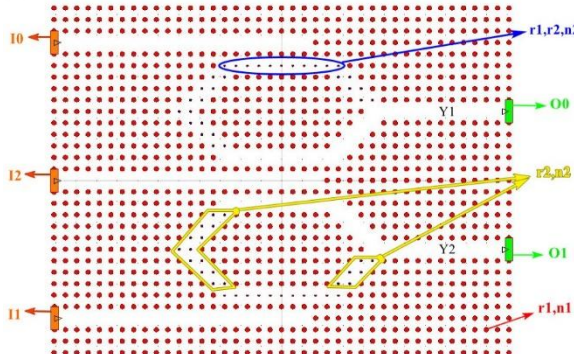
شکل ۲: ساختار بلور فوتونی رمزگذار تمام نوری پیشنهادی
