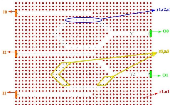
شکل ۲: ساختار بلور فوتونی رمزگذار تمام نوری پیشنهادی
