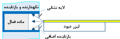
شکل ۳: طرحی از تیغه لیزر با لایه‌نشانی از سه طرف و روزنه دممش.
