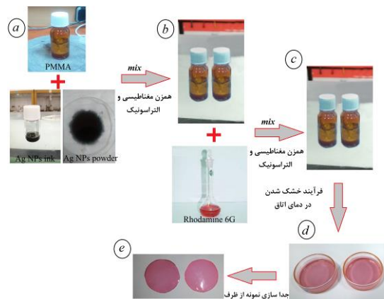
شکل ۲: مراحل ساخت فیلتر پلیمری
