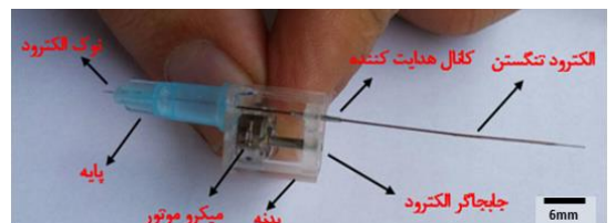
شکل ۳: تصویر میکروجابجاگر موتوردار ساخته شده در آزمایشگاه
