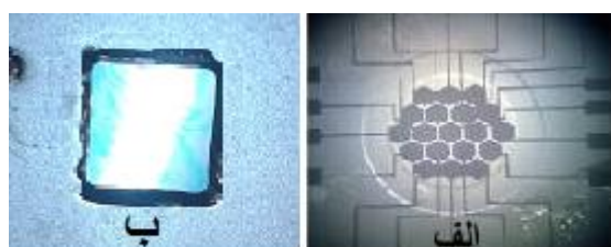
شکل ۳: الف) تصویری از الکتروودهای شش ضلعی به همراه دیواره (ب) دیافراگم پلیمری
