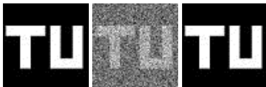
شکل ۲: تصاویر حاصل از شبیه‌سازی عددی. الف) تصویر اصلی. ب) تصویر گوست به روش مرسوم. ج) تصویر گوست به روش ما
