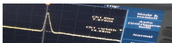
شکل ۵: پهنای زمانی پالس لیزر اندازه گیری شده بر روی نوسان نما نشان داده شده است.
