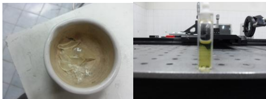
شکل (۳) در سمت راست پلی‌استر مایع و در سمت چپ پلی‌استر سخت سازی شده توسط لیزر را مشاهده می‌کنید.
