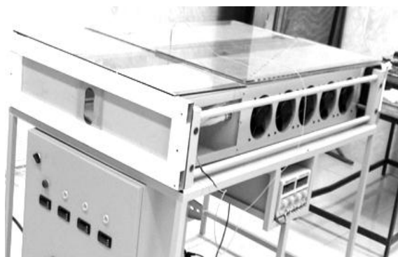
شکل (۲) نمونه ساخته شده از محفظه شبیه ساز تلاطم جوی در آزمایشگاه انتشار پرتو لیزر در جو
