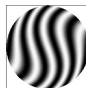
شکل ۶: الگوی تداخلی بیانگر افت کیفیت در سامانه، در نتیجه‌ی ایجاد عدم هم‌مرکزی به میزان DCY=0.1\text{mm} در لنز اول
