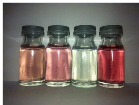
شکل ۴: به ترتیب از راست نمونه نانوذرات طلا، دی اکسید تیتانیوم، ترکیب آنها قبل از تابش لیزر ۵۳۲ نانومتر و آلیاژ آنها.
