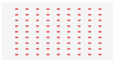
شکل ۲) ساختار مربعی بلورفوتونی دو بعدی با شکل میله های مربعی
