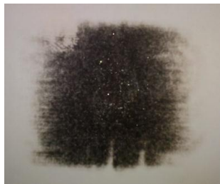
شکل ۸- تصویر تاثیر پالس لیزر روی کاغذ فکس (با سطح مقطع حدود ۳*۳ cm)
