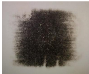
شکل ۸- تصویر تاثیر پالس لیزر روی کاغذ فکس (با سطح مقطع حدود ۳*۳ cm)
