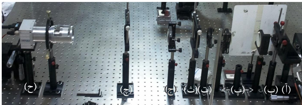
شکل ۵: چینش موازی ساز به همراه دوربین (لنز و CCD) - (آ) LED، (ب) گشودگی اولیه، (پ) لنزهای 4f، (ت) Pin Hole، (ث) گشودگی پرتوی خروجی، (ج) عدسی موازی کننده خروجی، (چ) فیلتر شدتی ND Filter، (د) CCD و لنز قابل جابجایی.
