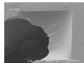
شکل ۴: تصویر SEM دیافراگم (عمدا) سوراخ شده برای نشان دادن معلق بودن بلور فوتونی
