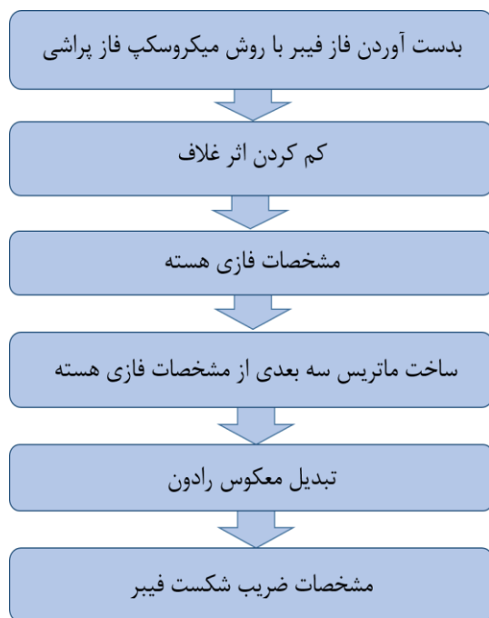
شکل ۱- روش بدست آوردن پروفایل ضریب شکست فیبر
