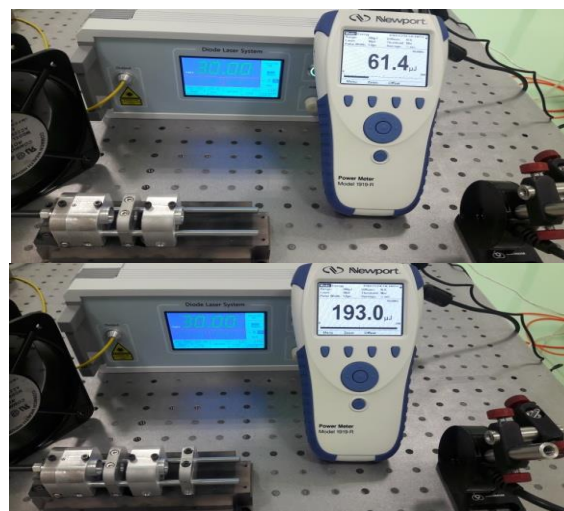
شکل ۴- چیدمان آزمایشگاهی میکرولیزر تقویت شده به روش جاروب پمپ جذب نشده و انرژی خروجی از میکرولیزر (شکل بالا) و تقویت کننده (شکل پایین)
