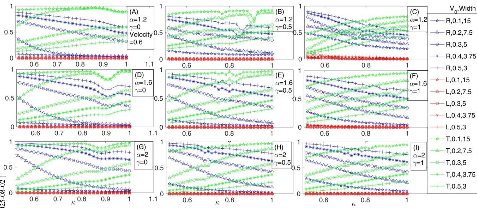
انعکاس غیریکنواخت می‌شود. به عنوان مثال در مورد پنل  $G$ ، که مربوط به معادله دیفرانسیل غیرکسری (معمولی) و خطی است، با افزایش  $K$ ، در مورد حالت‌های اول تا سوم روند کاملاً نزولی در ضریب انعکاس مشاهده می‌شود. زمانی که معادله از حالت خطی خارج شود و به پنل  $H$
