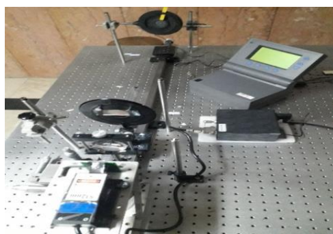
شکل ۱: تصویر چیدمان روبش محوری استفاده شده برای محاسبه ضریب شکست
