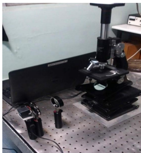
شکل ۲: چیدمان میکروسکوپی فازی به روش پراش فرنل
