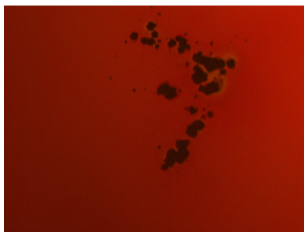
شکل ۵: مورفولوژی آسیب بر روی لایه پادبازتابنده
