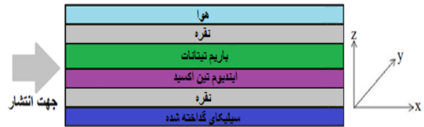
شکل ۱- پیکربندی مدولاتور پیشنهادی.
