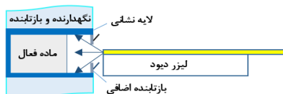
شکل ۳: طرحی از تیغه ی لیزر با لایه نشانی از سه طرف و روزنه دمش.
