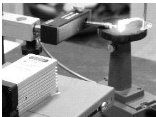
شکل ۱: آرایه آزمایش طیفسنجی فلوئورسانس القایی لیزری بلورها
