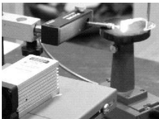
شکل ۱: آرایه آزمایش طیفسنجی فلوئورسانس القایی لیزری بلورها
