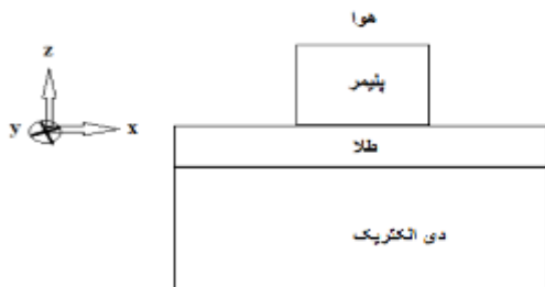
شکل ۱: یک نما از سطح مقطع ساختار DLSPW مورد بررسی
