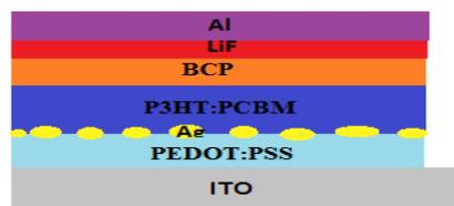
در لایه فعال پلیمر: فولرین کمتر از الکترون‌هاست. این بدین معناست که حفره‌ها آهسته‌تر از الکترون‌ها به فصل مشترک‌ها می‌رسند. از سوی دیگر، میدان الکتریکی موضعی در مجاورت نانوذرات نقره که با تشدید پلاسمون-های سطحی موضعی نانوذرات ایجاد می‌شود، با افزایش فاصله از ذره، کاهش می‌یابد. بنابراین، حفره‌های نزدیک به فصل مشترک بین لایه‌های میانگیر و فعال می‌توانند از میدان الکتریکی قوی‌تری بهره‌مند شوند و باعث تسریع در انتقال حفره‌ها به آند می‌شود.
