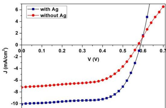
شکل ۴: منحنی مشخصه چگالی جریان-ولتاژ، با حضور نانوذرات پلاسمونیک نقره و بدون حضور آن‌ها تحت روشنایی
