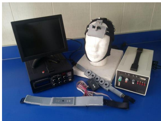
شکل ۱. دستگاه‌های fNIRS ساخته شده در آزمایشگاه تصویربرداری پزشکی نوری [۶].
