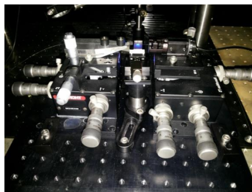
شکل ۴: تصویری از چیدمان تزویج نور چشمه گسیل خودبخودی تقویت شده هنگام نوشتن توری براگ توسط نور لیزر آبی ۴۷۳ نانومتر
