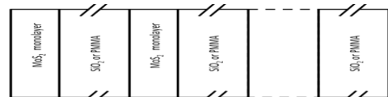
شکل-۲. طرحی از بلورهای فوتونی ساخته شده از لایه های متناوب
