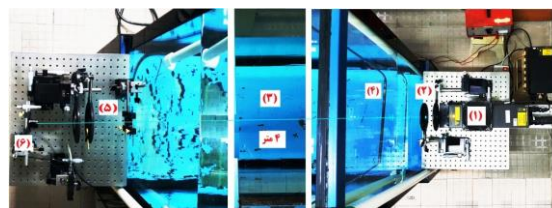
شکل ۱: چیدمان سامانه شبیه ساز انتشار امواج اپتیکی در زیر آب
