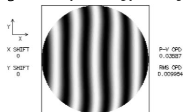
شکل ۶: الگوی تداخلی در صورت خروج از تلرانس ضخامت مرکزی عدسی جبران کننده به میزان 0.05mm
