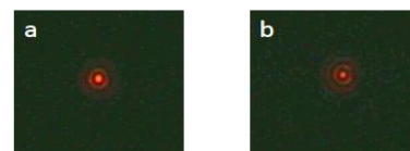
شکل ۱۴: نقاط کانون عدسی شعاع ۸,۵ میلیمتر: a نقطه‌ی کانون در ۶۰۰ میلیمتر، b نقطه‌ی کانون در ۱۰۰۰ میلیمتر
