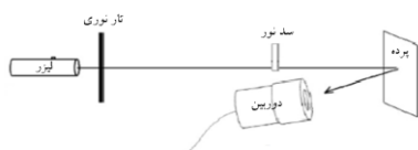
شکل ۴: نحوه‌ی قرارگیری سد نور در سر راه نور پراشیده شده از تار نوری.
