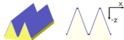
شکل ۱: سمت چپ شکل کلی ساختار، دیواره ها با زاویه دندانه ۷۷ درجه و لایه پوششی به اندازه ۳ نانومتر می باشد. شکل سمت راست سطح مقطع موجبر در صفحه XZ را نشان می دهد.
