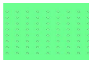
شکل ۳: شبکه ی نانولوله های کربنی عمود بر سطح انتشار امواج TE, TM با ثابت شبکه ی ۴۰۰ nm و شعاع نانو لوله ها ۵۰ nm.
