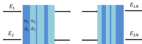
شکل ۱-۲: ساختار چند لایه‌ای لیزر تصادفی (لایه‌های رامان با ضخامت تصادفی در بین لایه‌های دی‌الکتریک)
