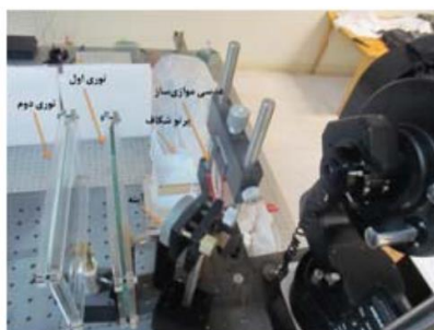
شکل ۱: چیدمان آزمایش به همراه نمای بزرگ شده حسگر ماره‌ای دو کاناله‌ی جبهه‌ی موج
