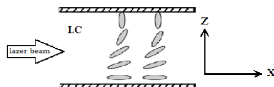
شکل ۱: تابش نور لیزر به سلول حاوی بلورمایع نماتیک هیبرید
