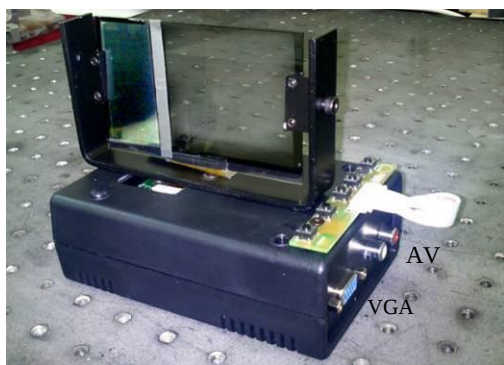
شکل (۲) نمایی از SLM شامل قسمت های عبوری و بازتابی، کلید های کنترل و ورودی های رایانه و دوربین
