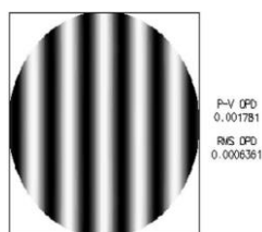
شکل ۳: الگوی تداخلی که بیانگر کیفیت محدود به پراش سامانه‌ی دو لنزی طراحی شده می‌باشد
